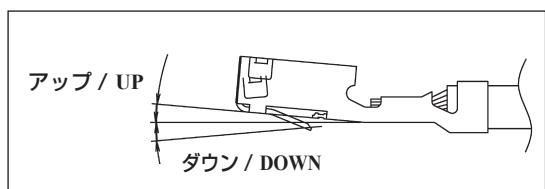
工具の調整状態や摩耗、端子の工具へのセット状態、端子の取り扱いにより発生する事があります。ベントアップ、ダウンが著しいと、ハウジングへの挿入が行えない事があります。
