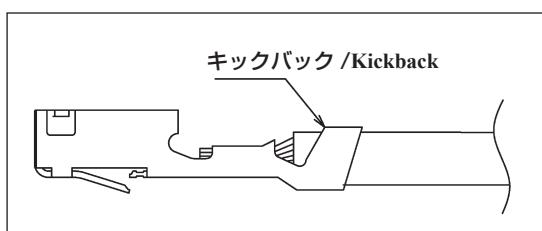
工具に適合しない電線を使用した時に発生する事があります。
