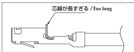
電線のストリッピング寸法が不適切な時や、工具への電線のセットの仕方により発生する事があります。
