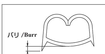
工具の調整状態やクリンパ、アンビルの摩耗、傷がある時、発生する事があります。バリが著しかったり著しく左右が不均一な事によりバリ部での端子の亀裂や、電気的接続の不安定、強度不足、端子の変形となる恐れがあります。
