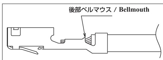
圧着を行った端子は、後部にベルマウスがあることを確認してください。ベルマウスの大きさは、端子により異なります。ベルマウスが無いと、ワイヤーバレル端面での芯線の断線や、圧着部の引っ張り強度不足となる恐れがあります。ベルマウスが大き過ぎる時は、電気的接続が不安定となったり、圧着部の引っ張り強度不足となる恐れがあります。
