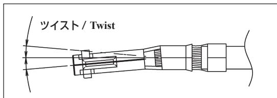
工具の調整状態や、工具への端子のセット状態、端子の取り扱いにより発生する事があります。ツイストが著しいと、ハウジングへの挿入が行えない事があります。
