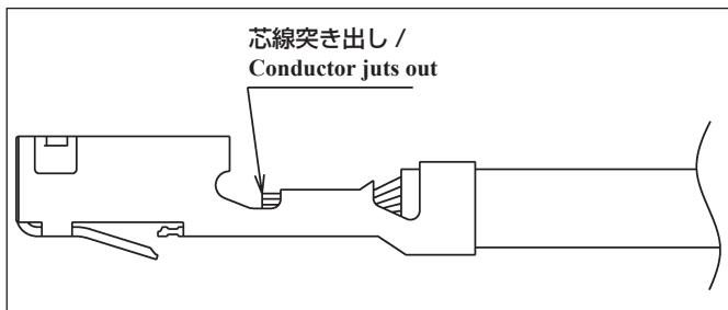
適正なストリップ長さ：圧着した際、ワイヤーバレル先端から芯線が突き出しており、また被覆がインシュレーショナーバレルより引っ込んでいたりシールドバレル内に入り込んだりしていない状態であること。
