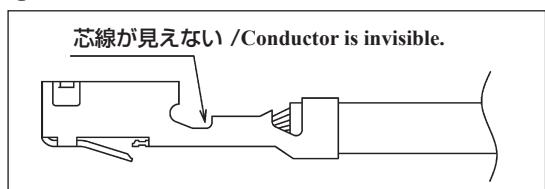
電線のストリッピング寸法が不適切な時に発生する事があります。
