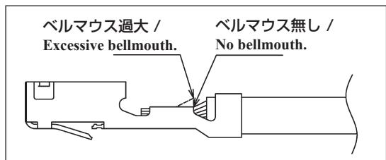
工具の調整状態や、工具への端子のセットの仕方により発生する事があります。ベルマウスが無かったり大き過ぎる事により、芯線の断線や引っ張り強度の不足、電気的接続の不安定となる恐れがあります。Caused by incorrect positioning of the contact in the crimping section of the tool. Can cause conductor break, low pull-out force or electrical connection failure.
