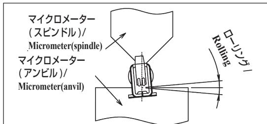
工具の調整状態や歯型の摩耗、工具への端子のセット状態、端子の取り扱いにより発生する事があります。ローリングが著しいと、ハウジングへの挿入が行えない事があります。
