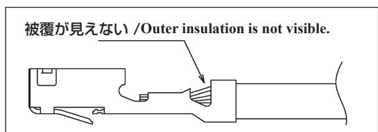
電線のストリッピング寸法が不適切な時や、工具への電線のセットの仕方により発生する事があります。
