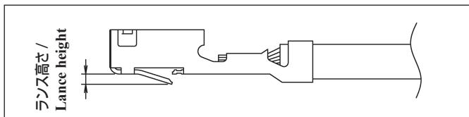
圧着した端子のランスの高さが所定の寸法内にあるか確認してください。
