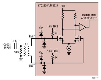
Figure 11. Transformer Driven ENC<sup>+</sup>/ENC<sup>-</sup>
