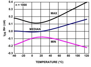
FIGURE 33. IOS IN+ vs TEMPERATURE, V<sub>+</sub>, V<sub>-</sub> = ±2.5V
