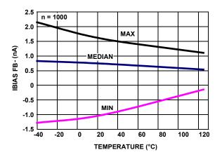
FIGURE 28. I<sub>BIAS</sub> FB- vs TEMPERATURE, V<sub>+</sub>, V<sub>-</sub> = ±2.5V
