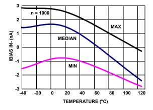
FIGURE 27. I<sub>BIAS</sub> IN- vs TEMPERATURE, V<sub>+</sub>, V<sub>-</sub> = ±2.5V
