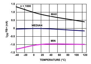
FIGURE 34. I<sub>OS</sub> FB+ vs TEMPERATURE, V<sub>+</sub>, V<sub>-</sub> = ±2.5V
