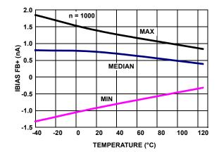
FIGURE 26. IBIAS FB+ vs TEMPERATURE, V<sub>+</sub>, V<sub>-</sub> = ±2.5V
