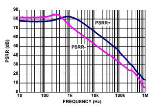
FIGURE 14. ISL28273 PSRR vs FREQUENCY
