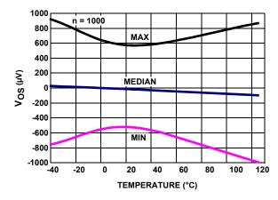
FIGURE 39. ISL28273 V<sub>OS</sub> vs TEMPERATURE, V<sub>+</sub>, V<sub>-</sub> = ±2.5V
