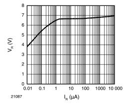
Fig. 4 - Typical Reverse Voltage  $V_{\mathsf{R}}$  vs. Reverse Current  $\mathsf{I}_{\mathsf{R}}$
